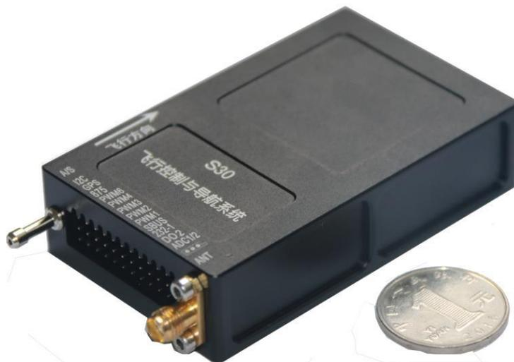
图 4 S30 多旋翼飞行控制系统
