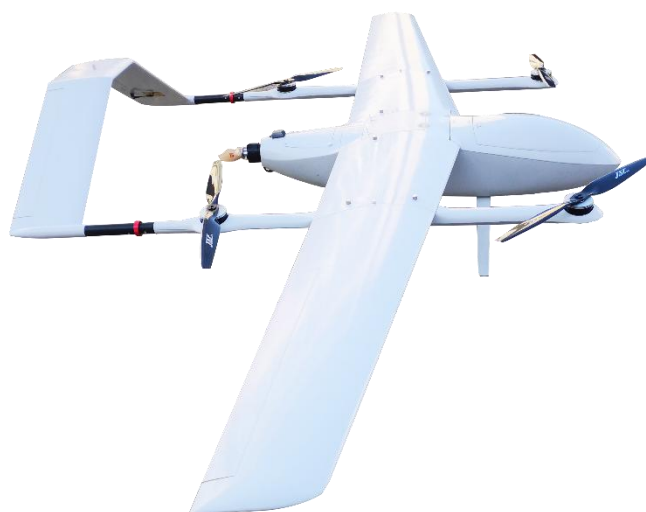
图 3 HC-525 垂直起降固定翼无人机飞行平台
