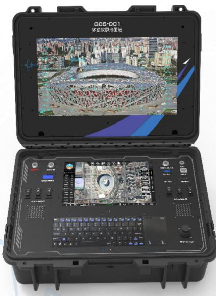
图 8 双屏移动式地面站
