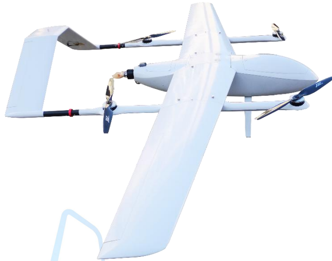
图 1 HC-525 垂直起降固定翼无人机
