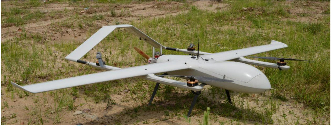
图 3 HC-530 垂直起降固定翼无人机飞行平台
