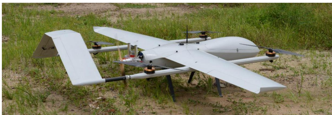
图 1 HC-530 垂直起降固定翼无人机
